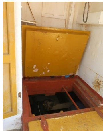
Εικόνα 12: Ανθρωποθυρίδα εισόδου στο χώρο καμπίνας πληρώματος (ανοικτή). Διακρίνεται (κλειστό) και το καπάκι του ψυγείου του πλοίου
