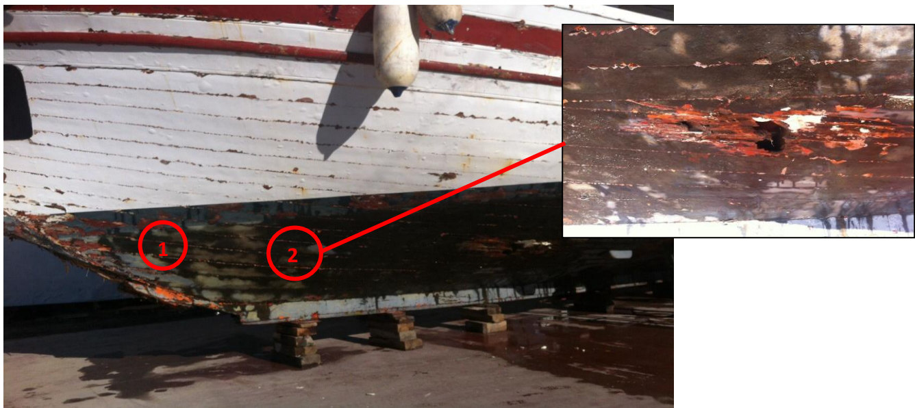
Εικόνα 9: Απεικόνιση των ζημιών που προκλήθηκαν στη γάστρα του ΠΑΝΑΓΙΩΤΗΣ Φ από την πρόσκρουση:
